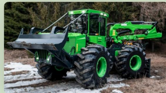
Neben dem Greifer kann am Hydraulikarm auch ein Harvester-Kopf der Hersteller SP Maskiner, Nisula oder Kesla montiert werden.
